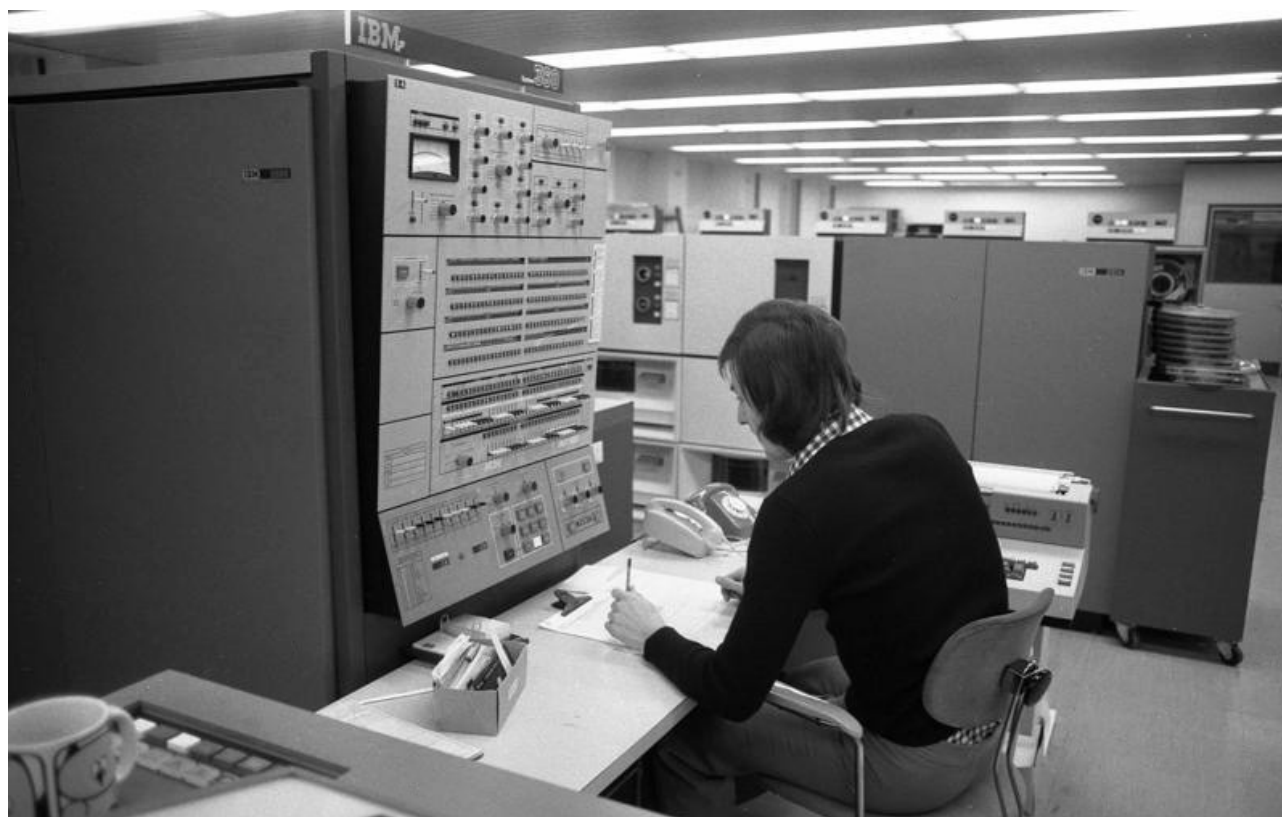
Figure 10 : La console d'un IBM System/360, ordinateur mis sur le marché en 1965 14 .
